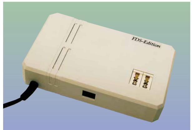
**Umschalter** Der Courier Varioswitch schaltet Gespräche, Telefaxe und Datenübertragungen, die über eine einzelne Telefonleitung kommen, automatisch auf Telefon, Fax oder Modem weiter.
