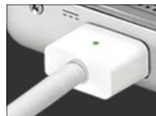
↑ **Stolpersicher** Der neue Verbindungsstecker für die Stromzufuhr hält magnetisch. Bei zu starkem Zug löst er sich automatisch und verhindert Unfälle.
