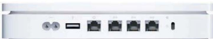
↑ **Anschlüsse** Time Capsule bietet dieselben Anschlüsse wie die Basisstation Airport Extreme. Dazu zählen vier Gigabit-Ethernet-Ports und ein USB-2.0-Anschluss für externe Festplatten oder Drucker.
