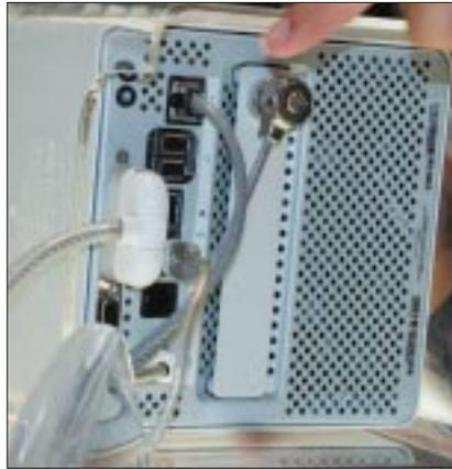
**EIN ZWERG MIT** allem, was die Großen auch haben: Ethernet, USB, Firewire, Modem und zwei Grafikausgänge bietet der G4-Cube. Die Technik versteckt sich allerdings am Boden des Würfels.
