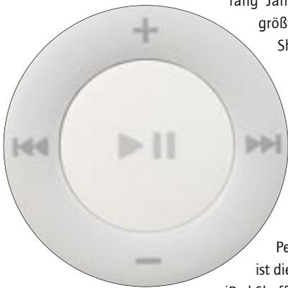
Blender Sieht aus wie ein Scrollrad, ist aber keines. Ohne Display gibt es nichts zum Scrollen, daher verbergen sich hinter dem geschickten Design nur die fünf Bedientasten.
