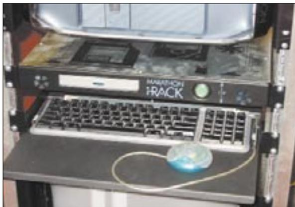
**iRack** Einen iMac im 19-Zoll-Rack zeigte die Firma Marathon. iRack lautet der Name. Sämtliche Komponenten des iMac inklusive CD-ROM-Laufwerk passen in ein 1,75 Zoll hohes Gehäuse.
