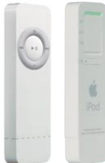
← **Tastenarm** Fünf Tasten auf der Vorderseite und ein Schiebeschalter auf der Rückseite genügen dem iPod Shuffle. Eine weitere Taste auf der Rückseite gibt Auskunft über den Akkuladestand.
