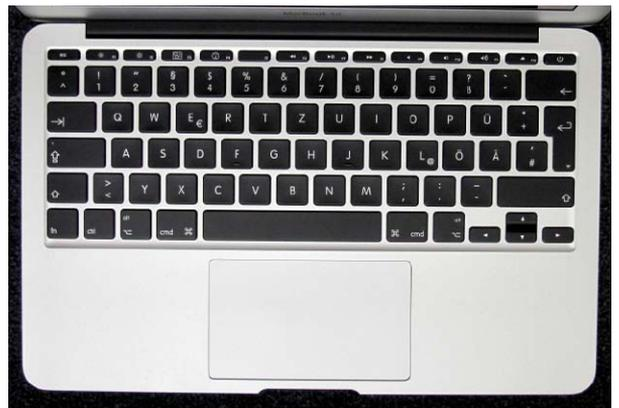
Die Tastatur des 11-Zoll-Modells ist fast genauso groß, wie bei allen anderen mobilen Macs. Lediglich die Funktionstasten am oberen Rand sind etwas kleiner. Die Tastaturbeleuchtung gibt es leider nicht mehr.
