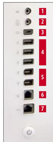
**Die Anschlüsse des iMac** 1 Audio-In 2 Audio-Out (analog/digital) 3 Mini-VGA 4 3x USB 2.0 5 2x Firewire 400 6 56k-Modem 7 Ethernet
