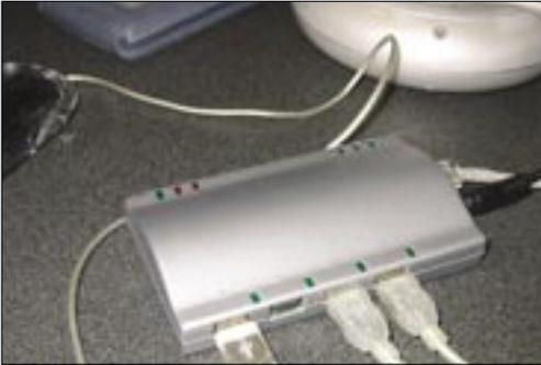
**USB via Ethernet** Für knapp 130 Dollar will Keyspan ab April den USB-Server auf den Markt bringen. Das Gerät ermöglicht es, beliebige USB-Geräte per Ethernet im Netzwerk zur Verfügung zu stellen.
