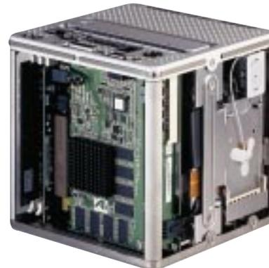
DIE INNEREIEN von links nach rechts: Im linken Bild sieht man die schwarze Festplatte, darüber die Pufferbatterie, die RAM-Steckplätze und die Grafikkarte (mit schwarzer Kühlrippe). Im rechten Bild erkennt man über dem silbernen Blech den Steckplatz für die Airport-Karte.
