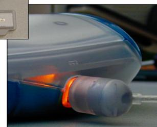
Lädt die Batterie, leuchtet der Ring um die Strombuchse orangefarben. Ist die Batterie voll, ändert sich die Farbe der Leuchte in Grün.
