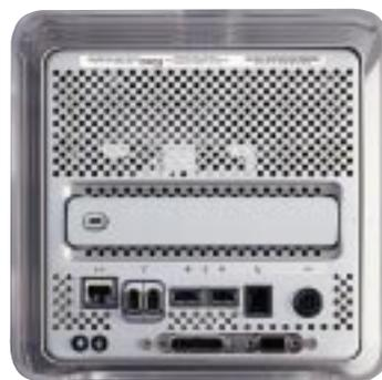
ALLE ANSCHLÜSSE DES CUBE von links nach rechts: Ethernet, 2x Firewire, 2x USB, Modem, Strom, Programmier- und Reset-schalter sowie Videoanschlüsse.
