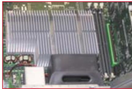
**Cool bleiben** Zwei Gigahertz-Prozessoren produzieren viel Wärme, die abgeführt werden muss. Deshalb kommt die wuchtige Kühlrippe des neuen Macs wie seine Kollegen nicht ohne eigenen Lüfter aus. Letzteren findet man aber auch beim Vorgängermodell.
