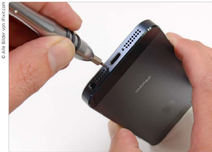
Bewährter Schraubendreher: Apple nutzt weiter Pentalobe-Schrauben, Geräte über asymmetrische Schrauben entbehren jeder Grundlage.
