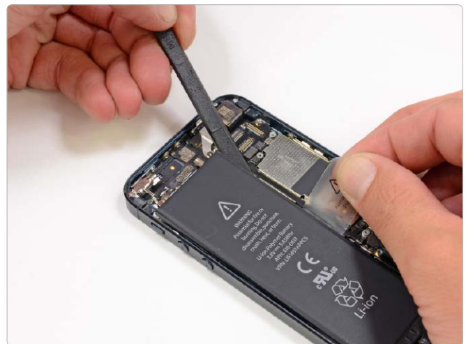
Das weit größte Bauteil, die Batterie, muss man nun abklebmen, bevor man mit dem Zerlegen fortfährt. Mit dem Spatel löst man die Batterie vorsichtig ab, sie ist nur mit wenig Adhäsionskleber fixiert. Eine modifizierte Chemie der Batterie erlaubt die geringfügig höhere Ladung von 1440 mAh – das iPhone 4S hielt 1432 mAh.
