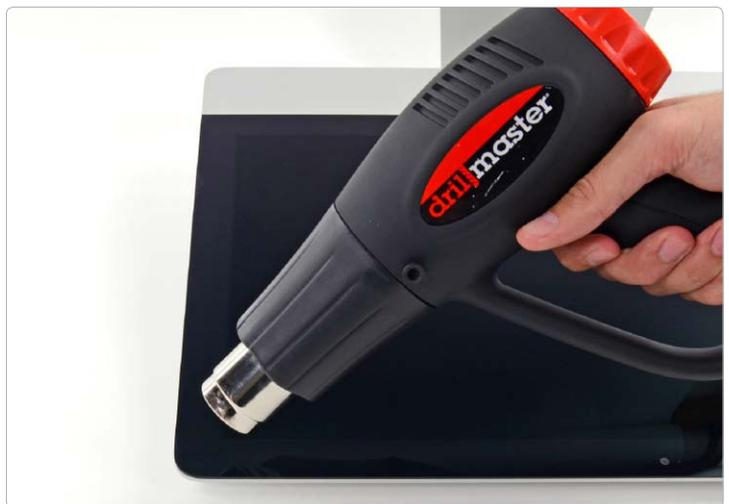
2. Die erste und vielleicht schwierigste Hürde beim Auseinandernehmen des neuen iMac ist das Display. Anders als beim Vorgängermodell wird das Display nicht mehr von Magneten und Schrauben gehalten, sondern von einem Gummirand. Der muss erst mit einem Fön weichgemacht werden, bevor man mit einem Plektrum und Saugnapfen das Display anheben kann. Insgesamt also ein sehr anspruchsvolles Verfahren, das Sie nur einem Experten überlassen sollten!
